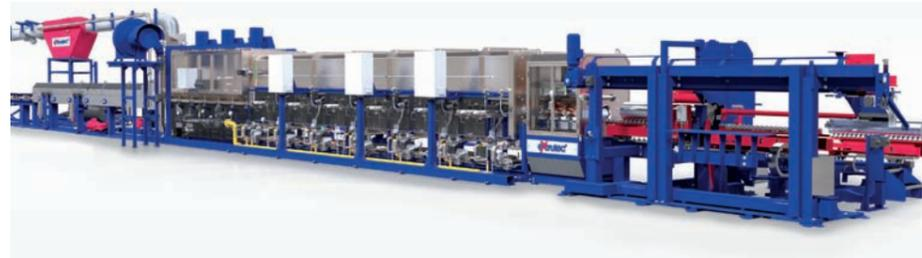
Der Eco Heating Process (EHP) als ausgeführte Anlagenkombination (patentiert)
